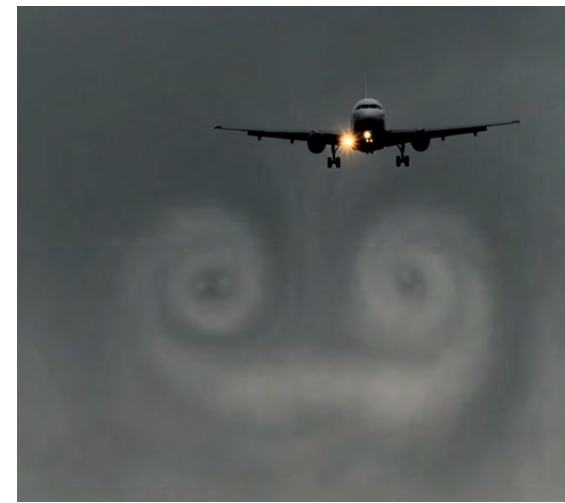
— Figuur 1.1: Voorbeeld van een vliegtuigwervel (vortex)
